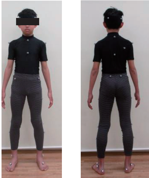
図1: Plug in gait model 標点マーカー (下肢・体幹・頭部) 23点
